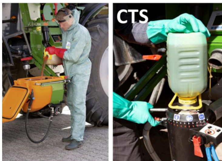
Fig.1- Incorporación producto de forma convencional y mediante un sistema de transferencia cerrado
